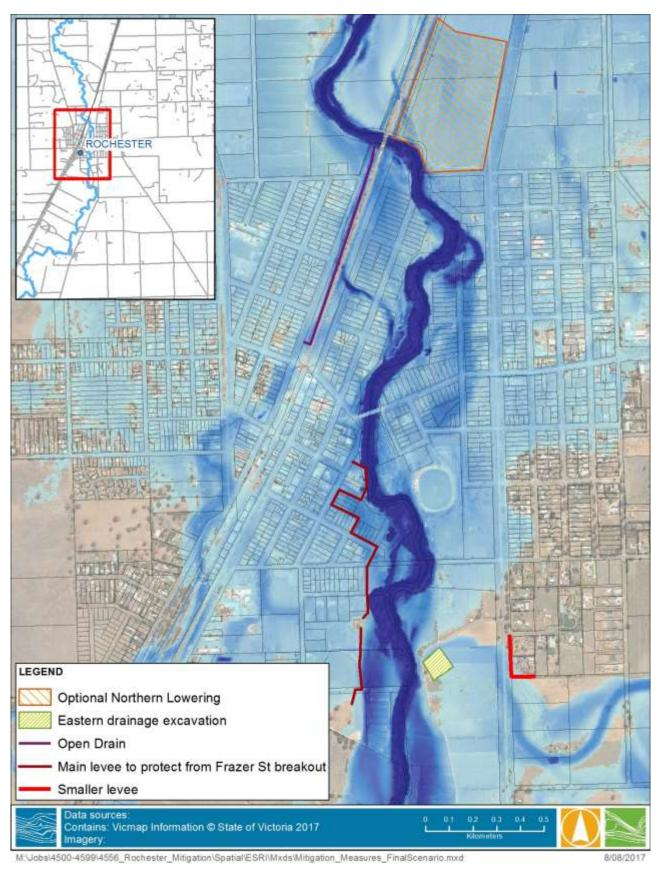
FIGURE 8-1 FINAL MITIGATION SCHEME KEY FEATURES – ROCHESTER TOWNSHIP
