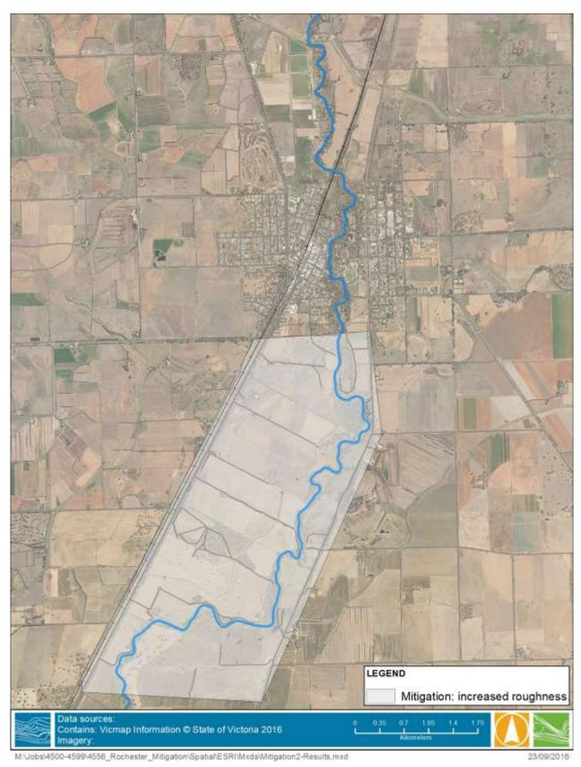
FIGURE 4-2 INCREASED ROUGHNESS AREA UPSTREAM OF ROCHESTER
