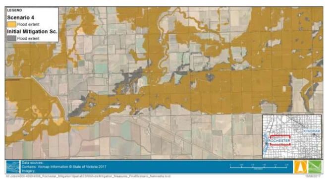
FIGURE 7-12 DIFFERENCE PLOT – SCENARIO 4 AND FINAL MITIGATION SCENARIO EXTENT COMPARISON ALONG THE NANNEELLA DEPRESSION. RESULTS SHOW THE EXTENT IS ONLY REDUCED MARGINALLY WHEN REDIRECTING WATER BACK TO THE RIVER UPSTREAM OF THE WARANGA CHANNEL
